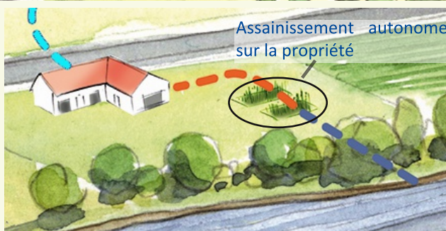
Habitation isolée possédant son propre système de traitement
